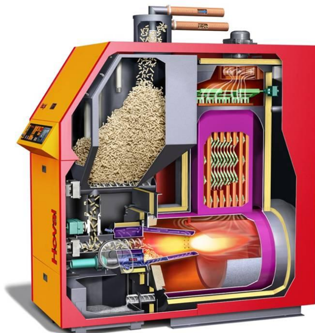
Fig. 4.1. Interior d'una caldera de pèl·lets de potència mitjana. Es pot observar el dipòsit intern que, per gravetat, serveix el pèl·let a un vis sense fi que en modula el subministrament al cremador. Per sota d'aquest, s'hi col·loca el cendrer, que recull les cendres del cremador, també mitjançant vis sense fi. A sobre la cambra de combustió hi ha el bescanviador que recull l'energia dels fums al seu pas cap a la xemeneia de sortida.
