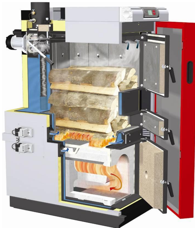
Fig. 4.3. Interior d'una caldera de biomassa per llenya amb flama invertida. Es pot apreciar la càmbra de càrrega de llenya just sobre la càmbra de combustió d'alta temperatura.
