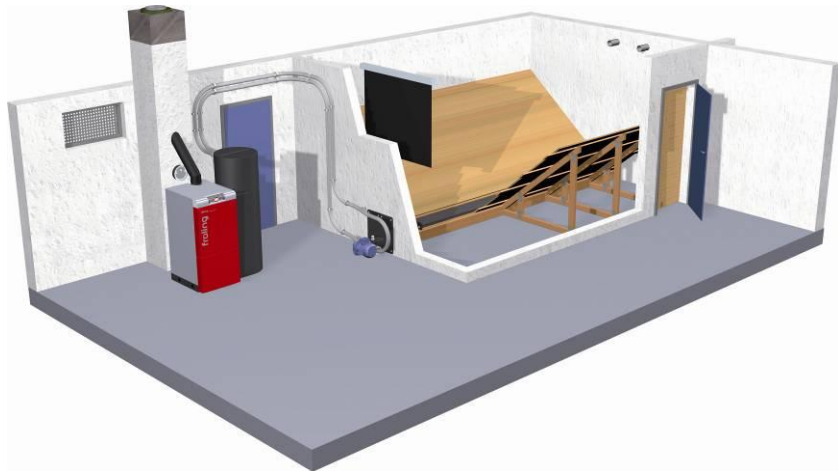
Fig. 5.13. Instal·lació de biomassa domèstica, amb sitja d'obra per a pèl·lets, on es pot apreciar la lona amortidora contraposada a les guillemines d'entrada del pèl·let i el sistema d'alimentació pneumàtic des del col·lector del vis sens fi fins a la tremuja adjunta a la caldera.
