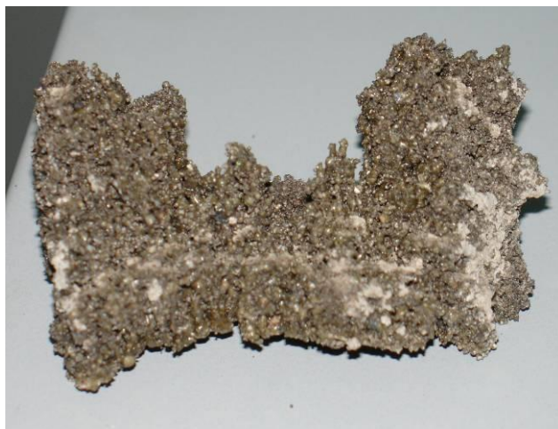
Fig. 2.2. Detall d'incrustacions extretes d'un cremador generades per la mineralització de cendres de pèllet.
