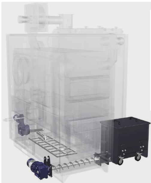
Fig. 6.2. Imatge de caldera de biomassa on es destaca el sistema de recollida de cendres. Es pot observar la graella mòbil sota el cremador que empeny la cendra cap a un vis sens fi que la porta finalment al cendrer.
