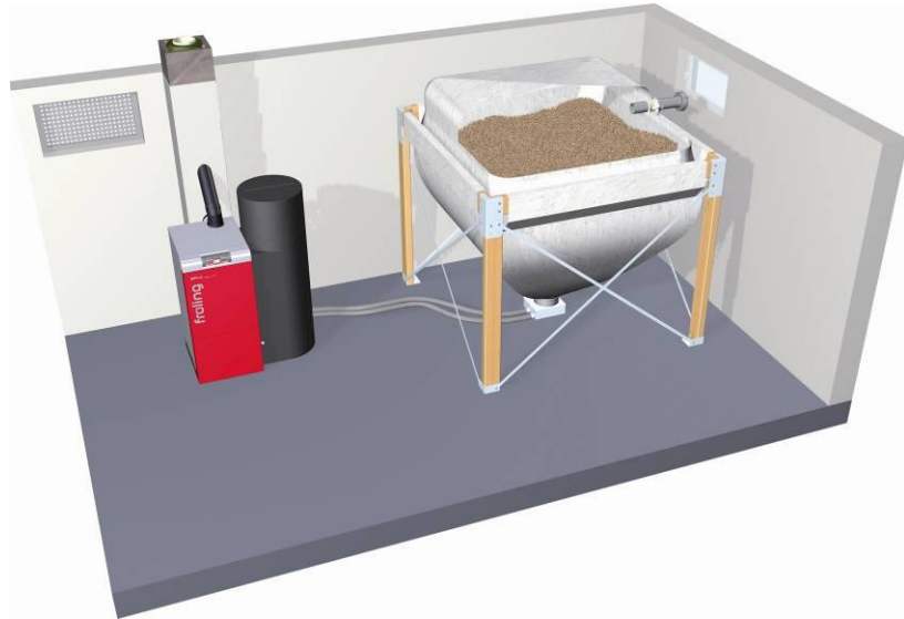
Fig. 5.14. Instal·lació de biomassa domèstica amb sitja tèxtil. Aquesta és equivalent a una sitja amb quatre pendents, en què el pelet es recull en un col·lector a la seva base des d'on s'alimenta la tremuja adjunta a la caldera mitjançant un sistema pneumàtic
